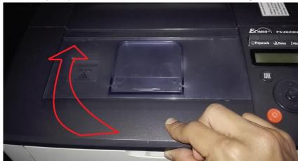
2. Al subir la tapa de la impresora se puede observar el toner y una palanca pequeña en la parte superior del toner, la cual se asegura automáticamente cuando se inserta el toner. Para retirar el toner es necesario mover la palanca hacia el lado derecho y subir el toner para retirarlo, para poner el toner se inserta a presión.
