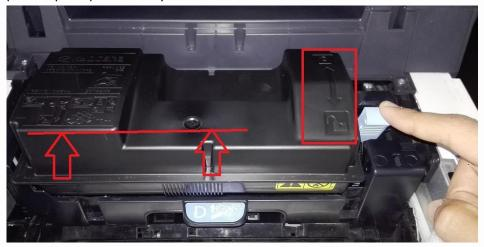
3. Para poner el toner, se inserta a presión y se debe asegurar, tirando la palanca hacia arriba, si esta palanca no se asegura, la tapa no pemirte cerrarse.
